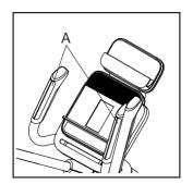
Для измерения вашей частоты сердцебиения возьмитесь ладонями за контакты, расположенные на датчиках пульсометра. Не двигайте руками во время измерения пульса и не пережимайте контакты.
